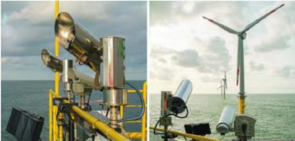
Alpha Ventus洋上風力発電の外側にある変電施設に設置された可視カメラ及び赤外線カメラ。カメラはローター回転域を監視できる位置に設置される。
