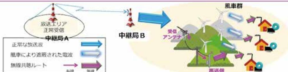
図 3-5 風車群による地上デジタル放送の受信障害例と救済方法
