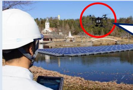
遠隔操作により太陽光パネルを点検するドローン
