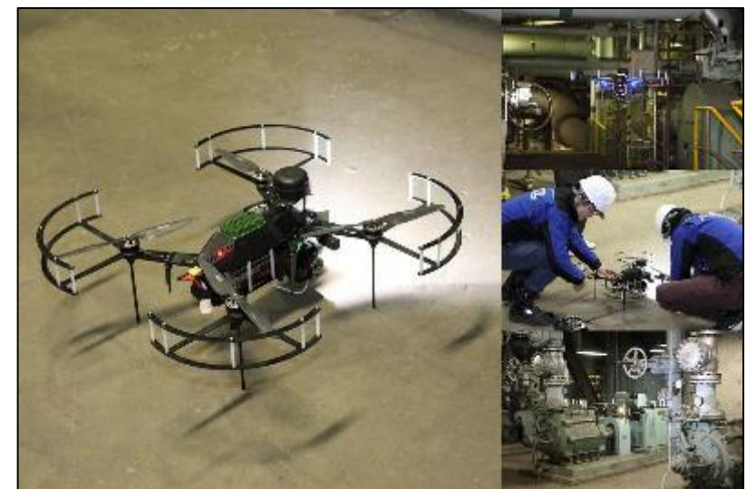
東北電力株式会社、日本ユニシス株式会社「秋田火力発電所での設備パトロール自動化に向けた実証試験の様子。細かな調整を繰り返しながら、複雑な火力発電所内をドローンが自律的に飛行し、摸擬した異常箇所を撮影していく（撮影：淡路敏明）」
