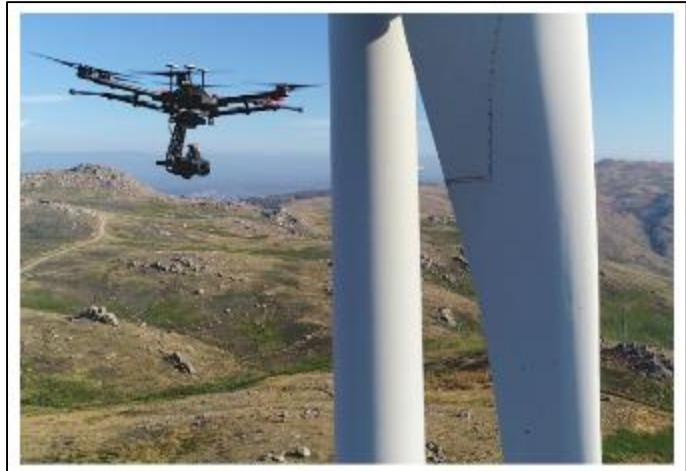
当社のSLAM技術を用いたドローンによる風力発電機の点検
