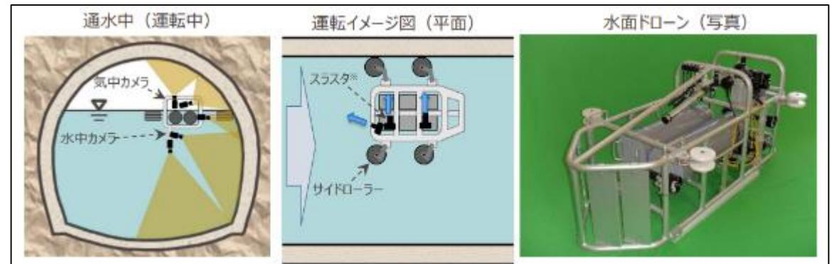
関西電力株式会社「水力発電所導水路の内部点検に活用する水面ドローンの開発について」
