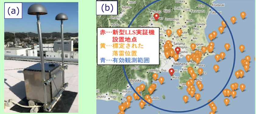
図2 (a) 新型LLS実証機, (b) 3機の実証機を用いた落雷位置標定結果
