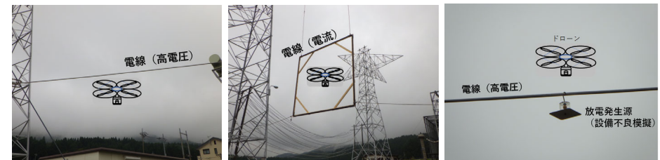
①商用周波電界 ②商用周波磁界 ③火花放電の放射電磁界 図1 電磁界影響を想定した試験例
