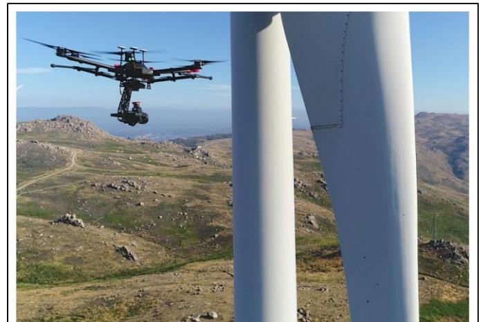
独自のSLAM搭載のシステムを取り付け、ブレード点検を行うドローン
