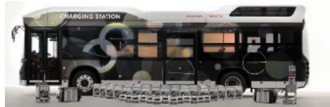
トヨタとホンダが蓄電池のバケツリレーを行う移動式発電・給電システム「Moving e」を2020年9月に発表
