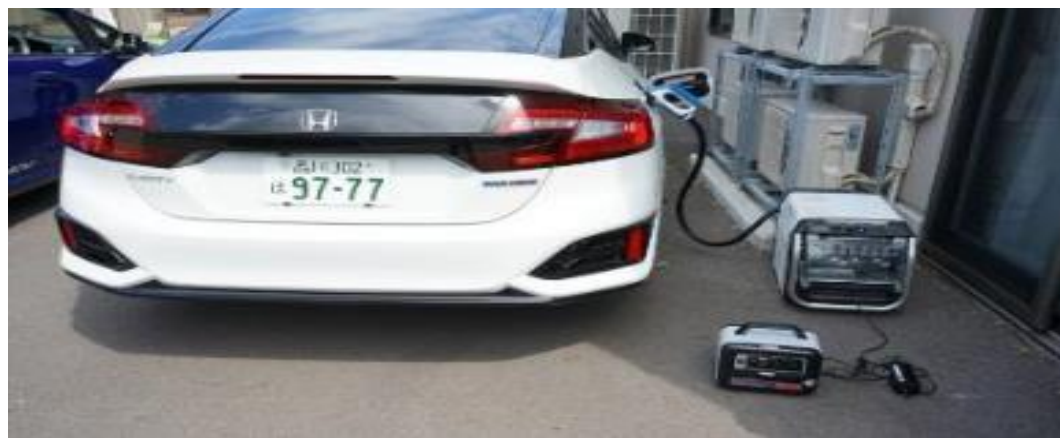
FCVからの給電：老人ホームでエアコンや小型蓄電池の充電に使用。（出典：本田技研工業株式会社）
