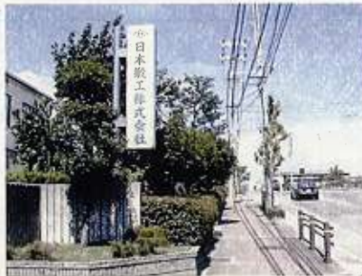
日本鍛工（株）様の事例 道路沿いに約 1m 幅の植栽帯を設けている。フェンスは植栽の中に後退して設置しているので、敷地内の緑を見せることができる。
