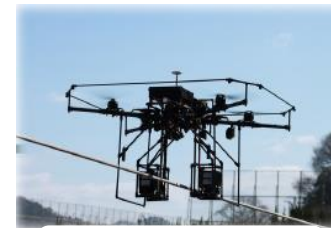
AI送電線点検システム
