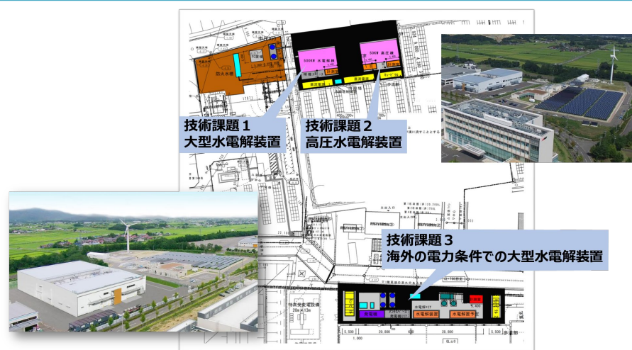
産業技術総合研究所 F R E A 内 水電解装置の評価設備配置案
