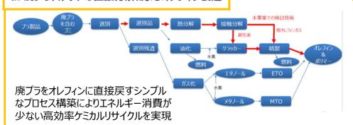
b. 廃プラスチック由来合成ガスを用いたエタノール製造
