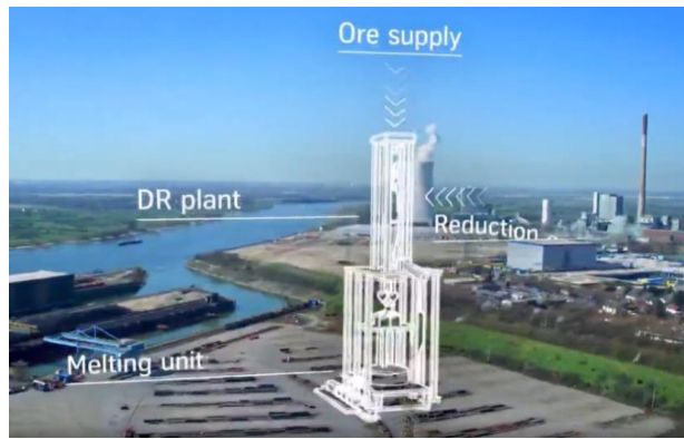
図 ThyssenKruppの直接還元炉
