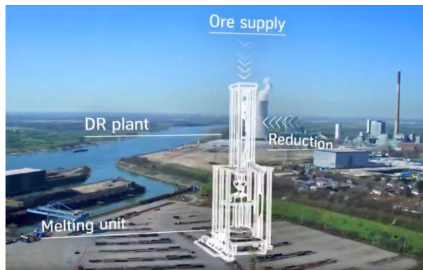
図 ThyssenKruppの直接還元炉
