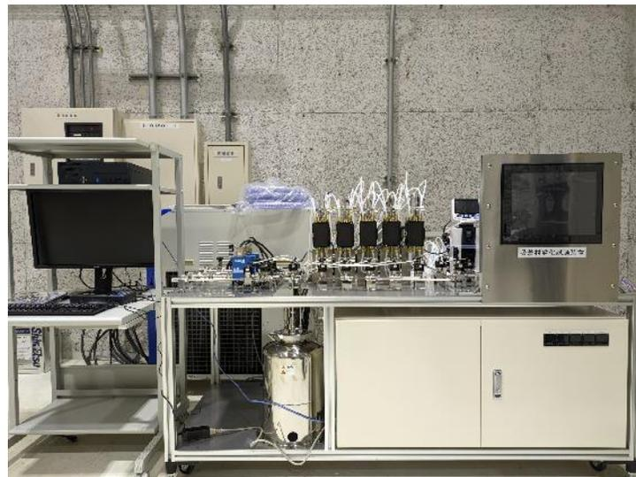
0.5～5 minで吸脱着を繰り返して、劣化試験料を調製。劣化挙動を処理ガス組成と相関
