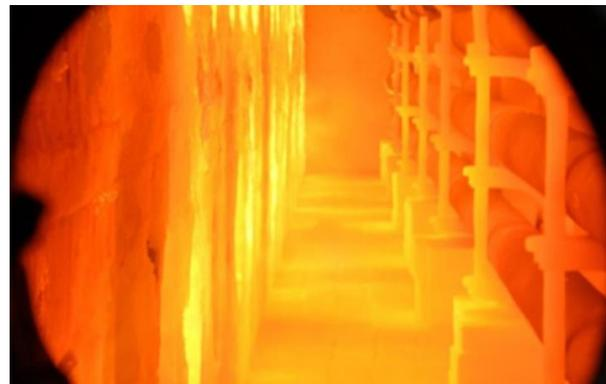
アンモニア燃焼時のナフサ分解炉内の様子
