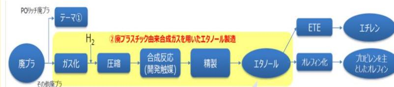
不純物を多く含む廃プラを合成ガス化し、それを原料にエタノールを製造するプロセスの実現
