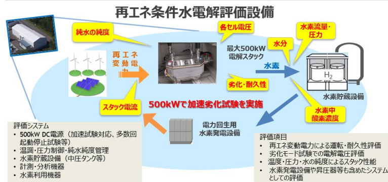
技術課題1：大型水電解装置のスタック評価、加速劣化評価 評価システムと項目のイメージ
