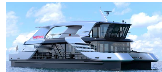
水素燃料電池船（大阪・関西万博で旅客運航中）
