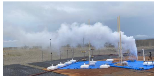
アンモニア小規模漏洩実験の様子（令和8年5月）
