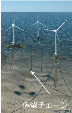
係留システムの一部をチェーンから合成繊維に置き換えることで、施工性が向上し、係留コストの低減が可能となる。複雑な地質の日本周辺海域の実情に適した合成繊維索からなる係留システムを開発する必要がある。
