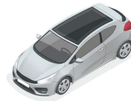
ルーフ用曲面太陽電池モジュールの搭載イメージ図
