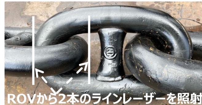
ROVから2本のラインレーザーを照射
