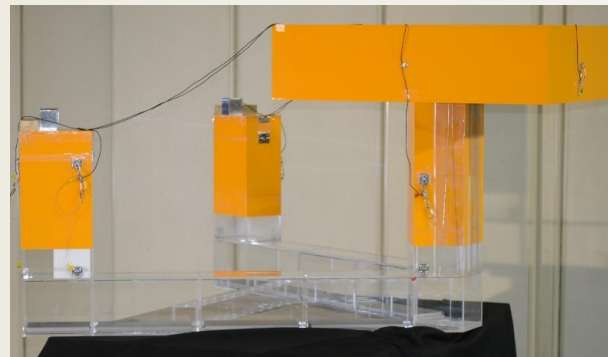
水槽試験用浮体模型
