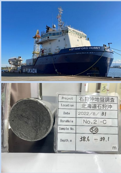
ドリルシップによるCPT調査・サンプリングの様子
