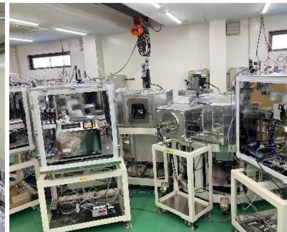
世界唯一のペロブスカイト太陽電池自動作製装置（稼働準備中）
