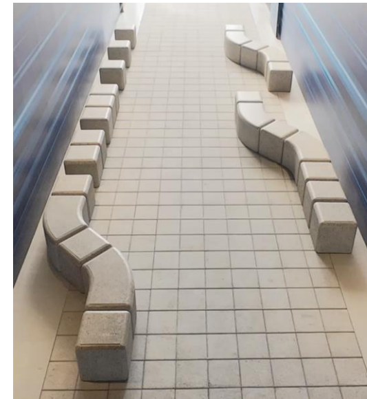
CO 2 固定コンクリートで製作されたベンチ (大阪・関西万博の会場*に設置)
