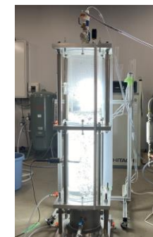
気泡塔試験装置
