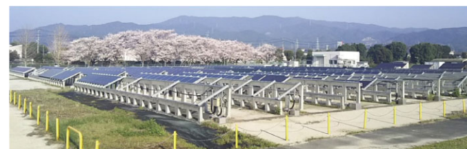
モジュールの屋外曝露試験サイト
