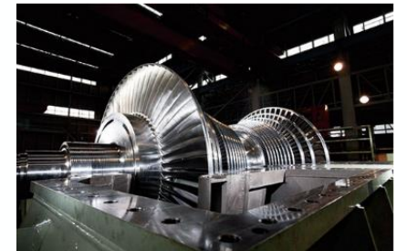
高腐食性対応のタービン
