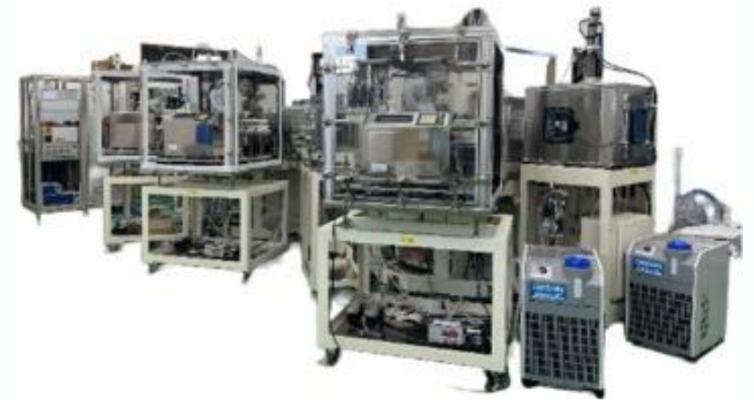
ペロブスカイト太陽電池自動作成装置自動 出典：産業技術総合研究所
