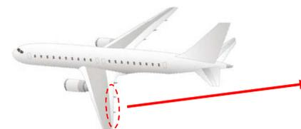
金属構造から熱可塑複合材使用による重量低減
