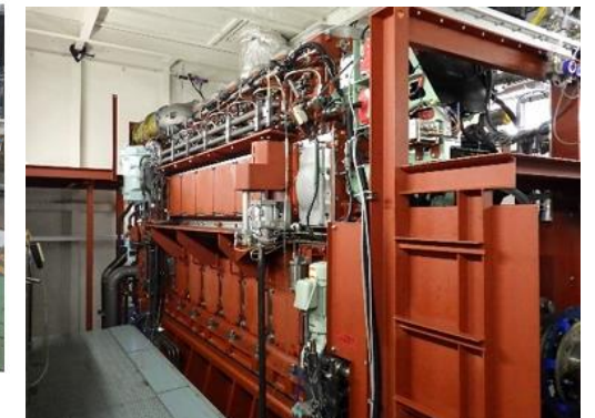
アンモニア燃料船用4ストロークエンジン実機 (IHI原動機)
