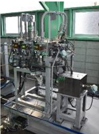
水素燃料噴射試験装置
