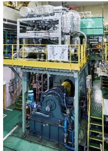
2ストロークアンモニア燃料試験エンジン
