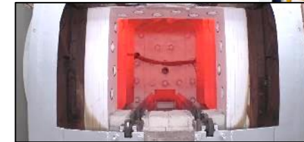
熱処理炉搭載ラジエントチューブバーナ
