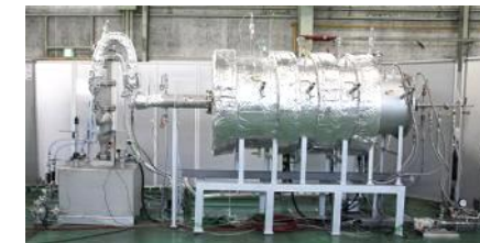
水素燃焼による有機フッ素化合物(PFAS)の脱炭素型分解処理技術
