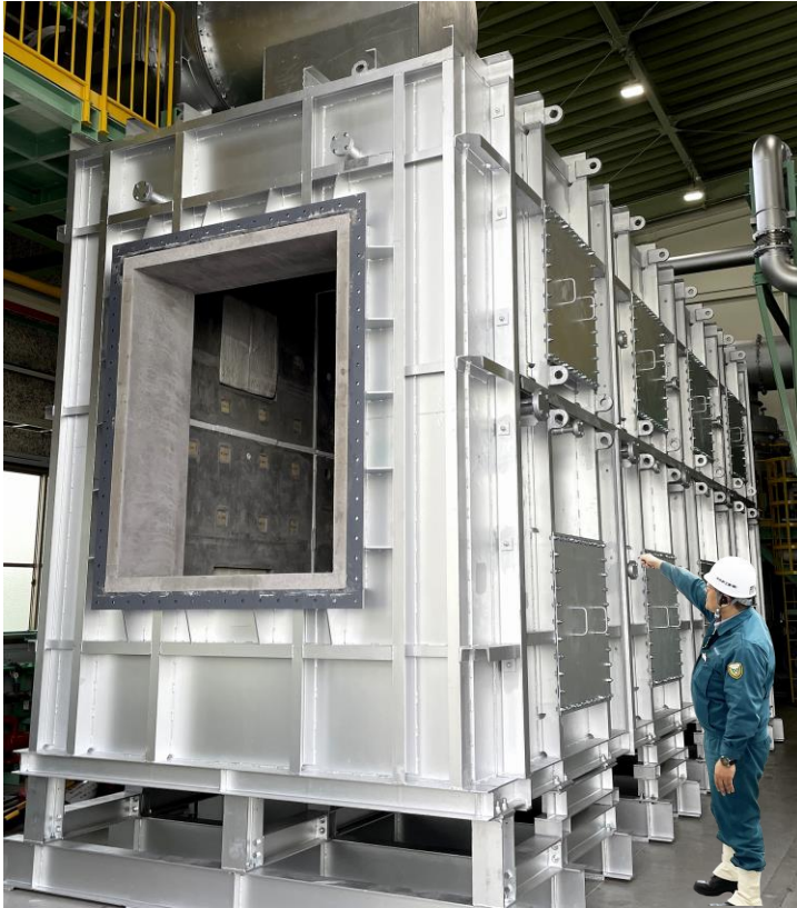
2.5MW 大型試験炉 (アンモニア燃烧式鉄鋼加熱炉の開発)
