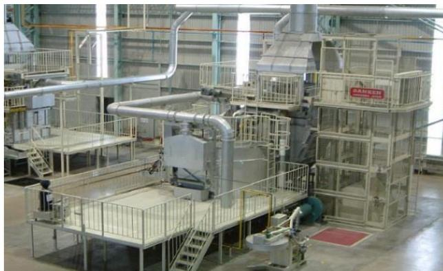
タワー型アルミ溶解炉
