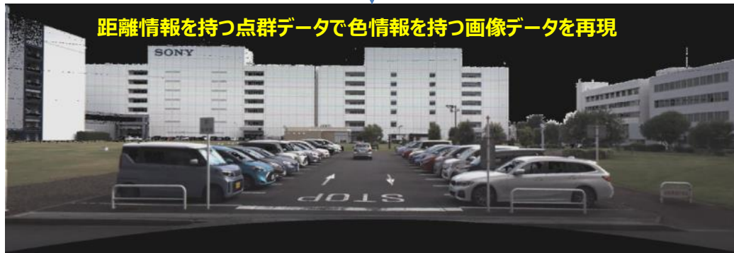
イメージセンサー+LiDAR 1chip化 距離+色
