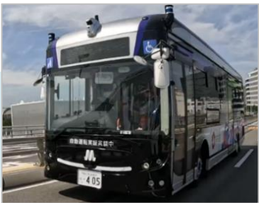
EVバス自動運転化改造 市内でのLv4運行に向けた自動運転実証
