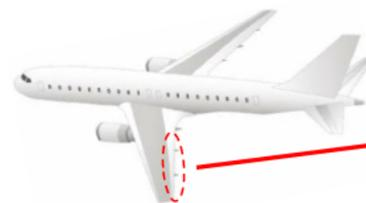
金属構造から熱可塑複合材使用による重量低減
