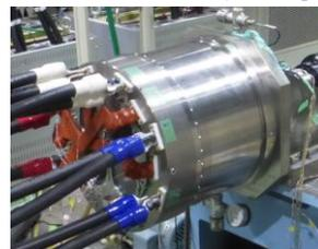
エンジン内蔵型電動機 (MW級発電機)
