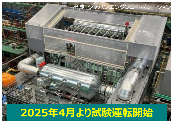
ジャパンエンジンの 舶用アンモニア燃料エンジン
