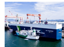
LNG/バンカリングの様子
