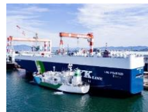
LNG/バンカリングの様子
