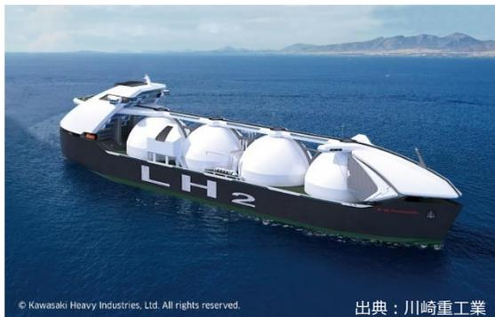
液化水素運搬船：160,000m<sup>3</sup>（4タンク分）
