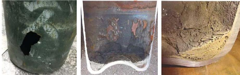
※炭酸ガス容器の腐食例（容器内に水分が混入し、炭酸イオンと容器母材が結合し炭酸鉄が生成）
