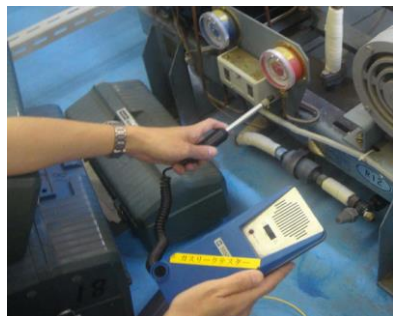
電子式漏えいガス検知装置法
