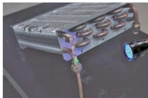
蛍光剤法（潤滑油中に蛍光剤を注入して蛍光ランプで検知）
