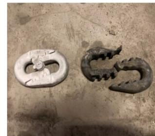
リターンプーリ摺動部の経年的な摩耗    チェーンカップリング先端部摩耗
