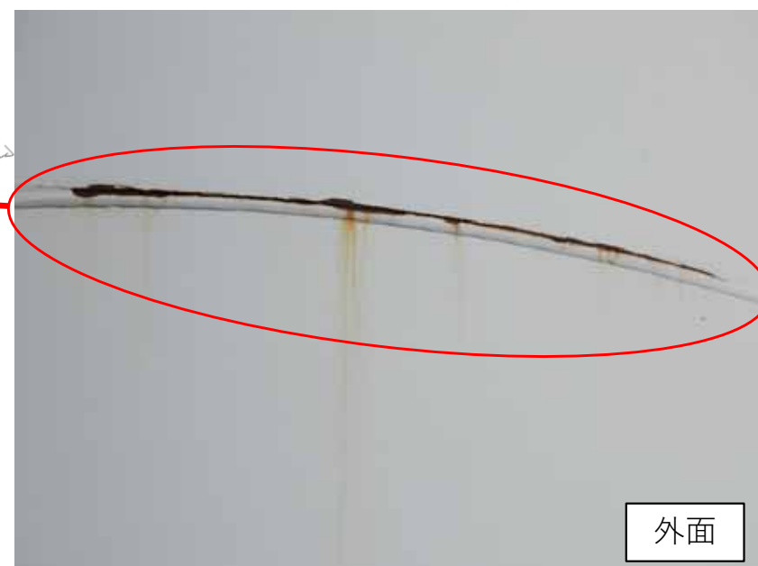
図4-6. 4-2号機の亀裂の調査：第4節亀裂方位(4/19調査時)
