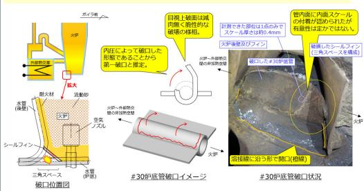
ボイラ損傷状況及び第一破口(推定)の特徴
