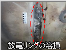
放電リング接続部の溶損
