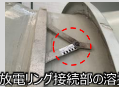
放電リングの溶損
