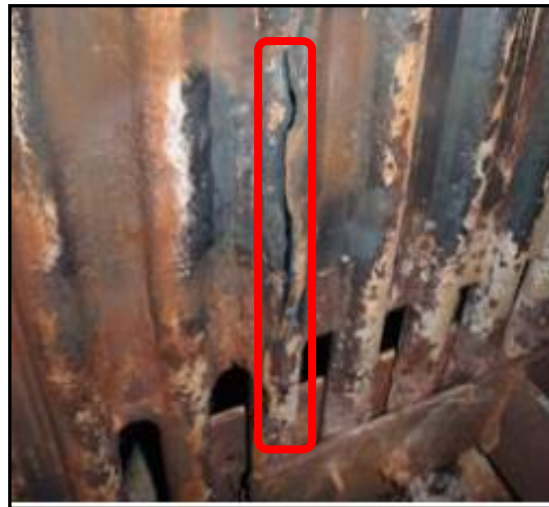
(写真1) ボイラーチューブの破孔
