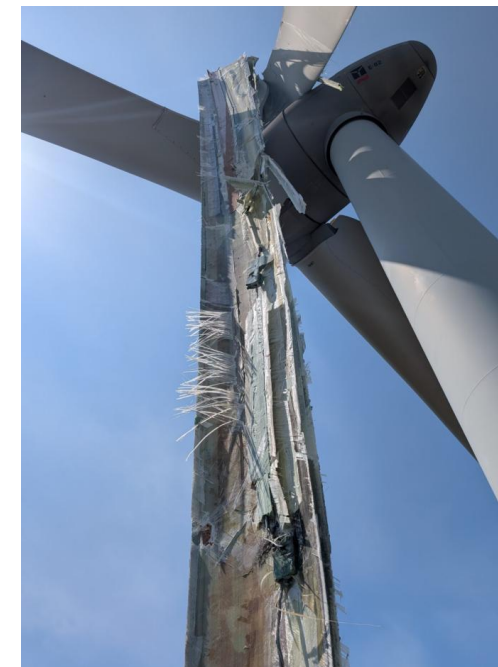
写真2: 破損したブレードCの近接写真 サクシオンサイド内側
