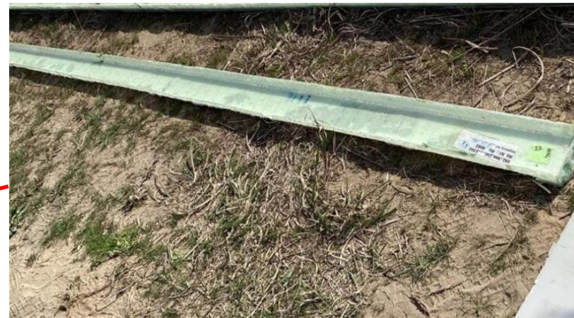
写真5: 22 ウェブ [全長約7.4m, 質量約16kg]
