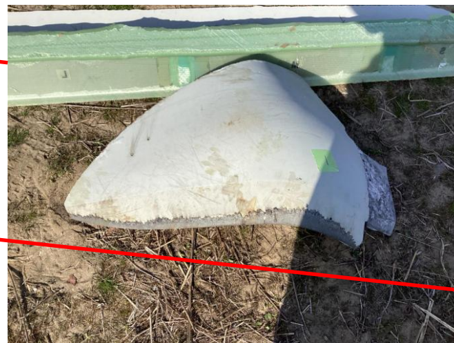
写真6: 1 先端セプター [全長約0.8m, 質量約11kg]
