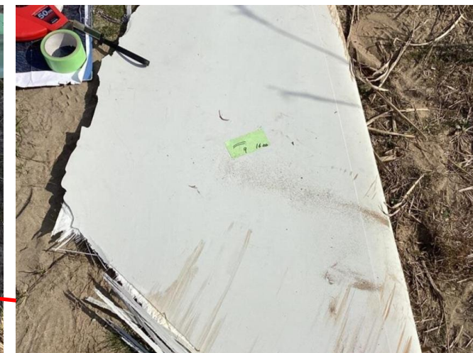
写真7: 9 プレッシャーサイド側シエル [全長約1.6m, 質量約11kg]
