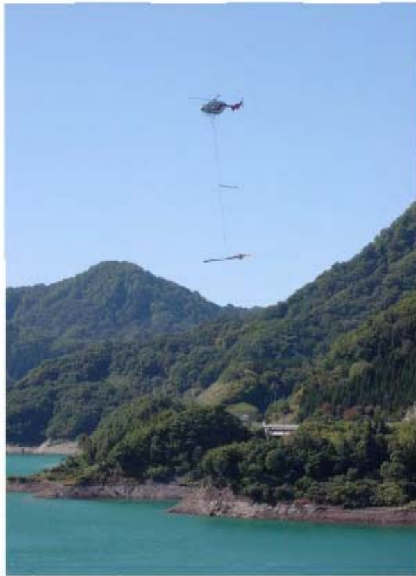
空中探査作業状況(空中地下探査システム)
