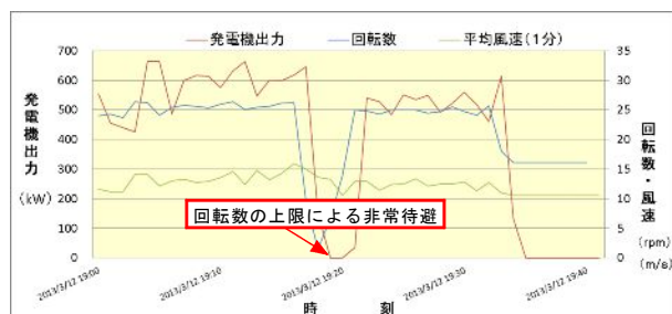
図2-2 3号機の運転状況(詳細)
