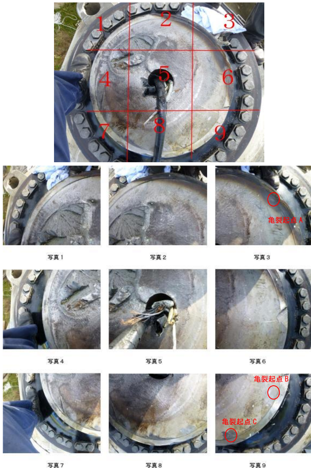
図 3-24 ハブ側主軸破断面
