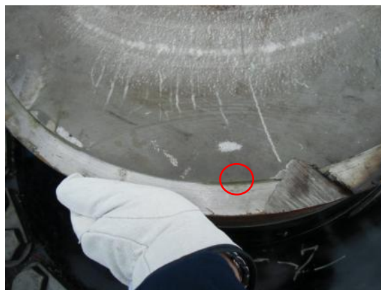
亀裂起点 B
