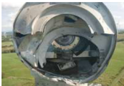
図-5 主軸破断面(ナセル側)
