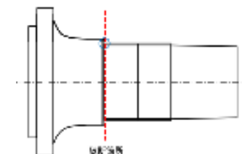
図-8 主軸断面図(事故機)
