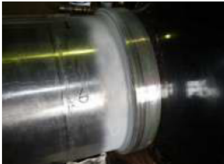
図-17 浸透探傷検査の良好例 (浜頓別 2 号)
