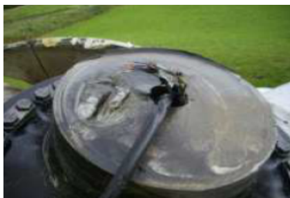
図-4 主軸破断面(ハブ側)
